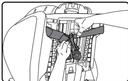
2. Presione con fuerza el gancho situado encima del punto del anclaje de retención.
