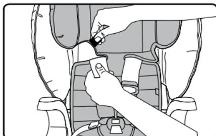
4. Desenganche las cintas elásticas superiores situadas en ambos laterales del reposacabezas.
