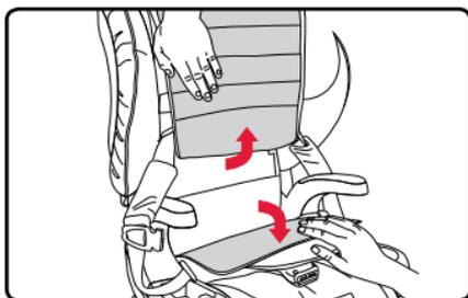
2. Desenganche las bandas elásticas que se encuentran en la parte trasera de la cubierta del asiento. Jale la cubierta del asiento y la pieza de espuma hacia adelante.
