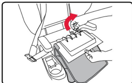
4. Gire y jale el retenedor de la hebilla por la ranura de la carcasa del asiento para niños. Desenganche los clips de retención que se encuentran en la parte trasera de la cubierta del asiento. Jale la cubierta del asiento hacia adelante y por encima de la almohadilla abdominal.
