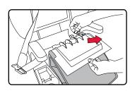
9 Suelte los enganches que se encuentran en la parte delantera de la cubierta del asiento del exterior del asiento de seguridad para niños y, a continuación, quite la cubierta del asiento.
