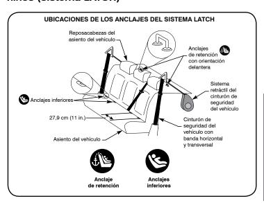
Los anclajes inferiores y las correas de fijación para niños o LATCH es un sistema disponible en este asiento para niños que ofrece una alternativa a los métodos de instalación del cinturón de seguridad del vehículo. La figura arriba muestra las posiciones habituales de los anclajes inferiores de las correas en un vehículo. Consulte las páginas 50-51 para conocer los componentes LATCH de este asiento para niños.
